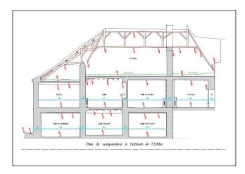
■ Les plans de coupe, encore appelé section, figurent, à leur endroit, les planchers, murs, cloisons, poutres visibles, plafonds, faux-plafonds, ouvertures avec altitude des allèges et linteaux, et l'ensemble des détails permettant de définir les hauteurs et éléments structurels de l'immeuble ou du local.
